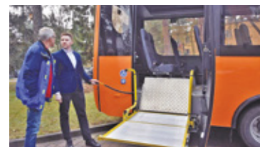
Nowoczesny autobus wyposażony jest w windę dla osób niepełnosprawnych
