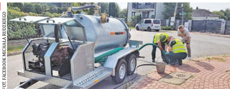
Przyczepa WUKO ma za zadanie czyszczenie osadników piaskowych, wpustów drogowych i studni chłonnych
